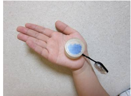
発汗センサケース直径35mm高さ20mm
